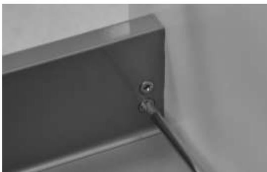
b\_ Agendo sulla vite inferiore si effettua la regolazione in altezza del frontale cassetto per  $\pm 2$  mm. Eseguita la regolazione, riattivare il blocco agendo sulla vite superiore.
