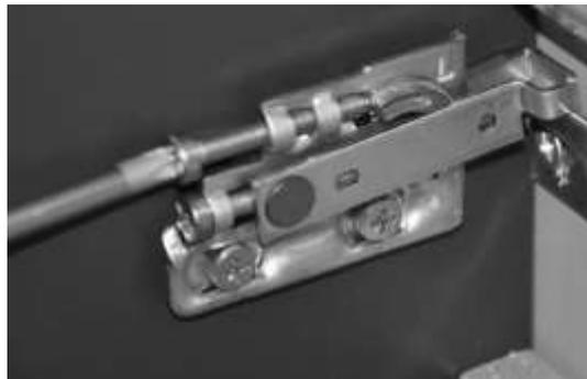
c\_ Procedere ora alla messa in bolla del mobile agendo sulla vite superiore delle attaccaglie come in figura.
