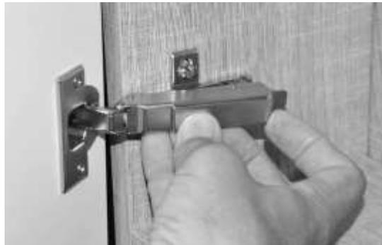
c\_ L'aggancio della cerniera avviene in modo automatico, a pressione, avendo cura di fissare prima la parte esterna nell'apposita sede.
