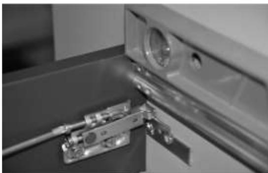
c\_ Procedere ora alla messa in bolla del mobile nella lunghezza, agendo sulla vite superiore delle attaccaglie come in figura.
