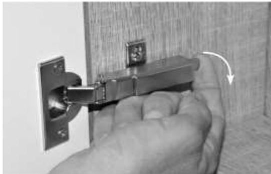
a\_ Lo sgancio della cerniera si effettua tirando verso di sé la levetta posta nella parte posteriore della cerniera.
